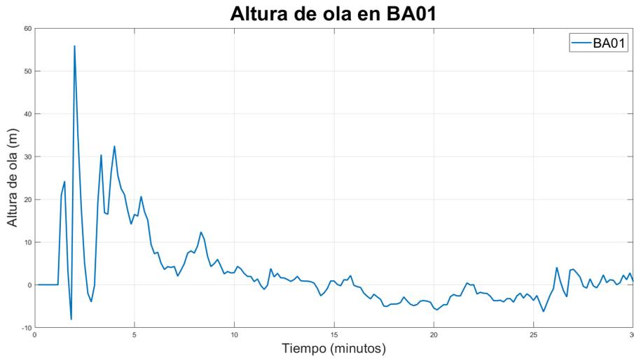
**Figura 4.1.2:** Altura de ola para el deslizamiento de tierra con el total de la masa desprendida en el mareógrafo BA01 durante los primeros 30 minutos.
