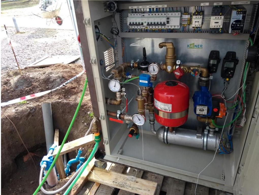
Ilustración 4-1: Foto test de Respuesta Térmica (TRT) conectado a pozo de estudio.
