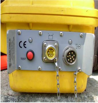
**Figura 3.3** – La otra vista lateral del Geode, posee un botón para testear el buen funcionamiento del equipo (botón rojo), una entrada para la conexión a la batería (puerto amarillo) y la conexión para agregar un Geode adicional.
