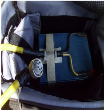
**Figura 3.9** – Batería de 12 *v* usada para alimentar al sismógrafo.
