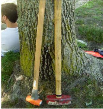
**Figura 3.7** – La fuente sísmica elegida fue un martillo tipo mazo que se golpea contra una placa metálica.
