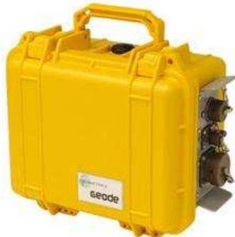
**Figura 3.1** – Sismógrafo de exploración, modelo Geode de la marca Geometrics. Puede registrar de 3 a 24 canales; posee una variedad de filtros (pasa altas, pasa bajas y pasa bandas); ajuste automático de ganancia, intervalos de muestreo de de 0,02, 0,03125, 0,0625, 0,125, 0,25, 0,5, 1, 2, 4, 8 y 16 ms; longitud de registro de hasta 16384 muestras; opción de disparo automático, manual y de monitoreo.
