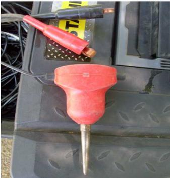
**Figura 3.5** – Geófono individual, se cuentan con 24 geófonos verticales de frecuencia de resonancia de 4,5 Hz y 24 de 14 Hz. También se aprecian los conectores (rojo y negro) que van al cable sísmico.
