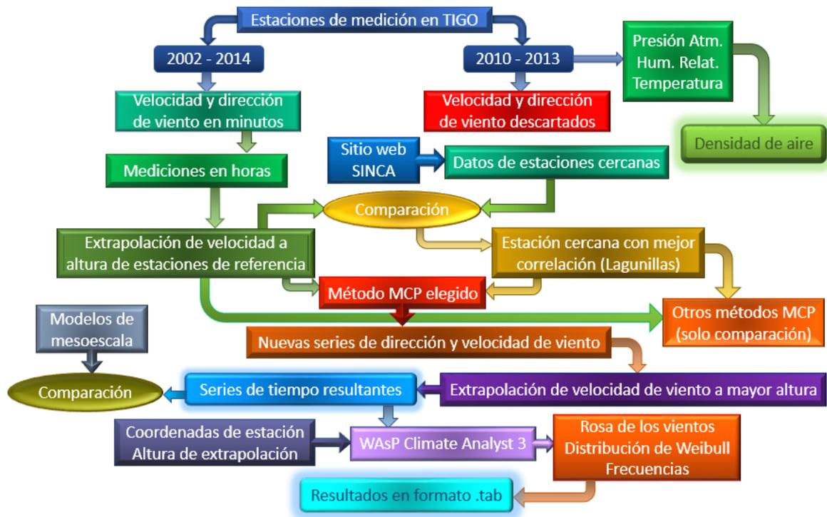
Figura 24. Esquema resumido del procedimiento llevado a cabo con las mediciones (primera parte).
