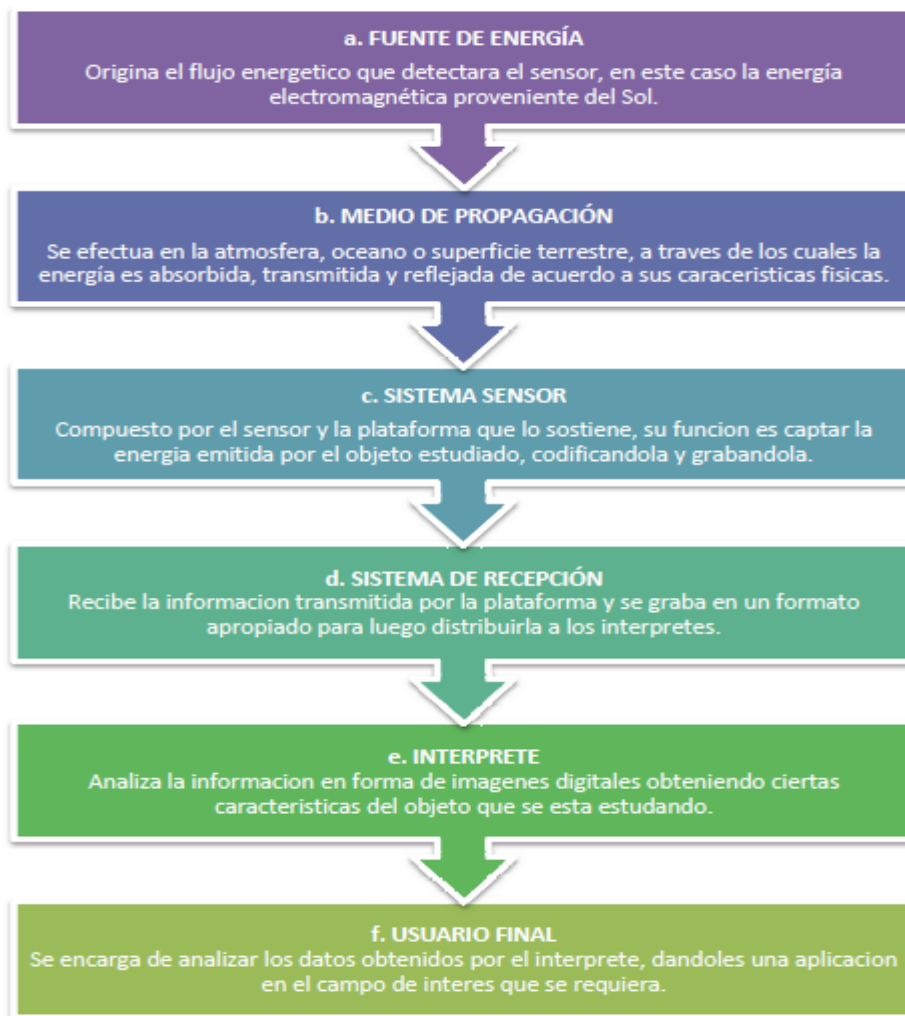
Figura 6: Estructura general de los procesos involucrados en la aplicación de técnicas de percepción remota (Fuente: Avalos, 2012).
