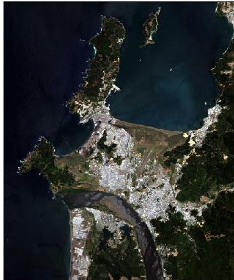
Figura 10: Resultado de las correcciones especificadas en la sección 3.2.2.3 aplicadas a una imagen del satélite Landsat 8 con fecha enero de 2017 (Fuente: Elaboración propia).
