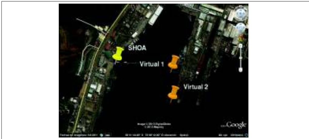
Figura 3.2: Amarillo: Ubicación del mareógrafo del SHOA del puerto de Talcahuano. Naranja: Ubicación de los mareógrafos virtuales generados en la simulación de tsunami.
