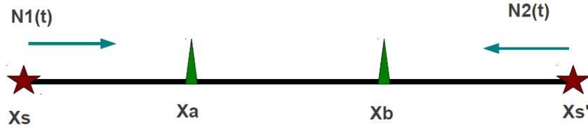
**Figura 3:** Representación de dos fuentes de ruido  $N_1(t)$  y  $N_2(t)$  actuando simultáneamente en las posiciones  $x_s$  y  $x'_s$ .
