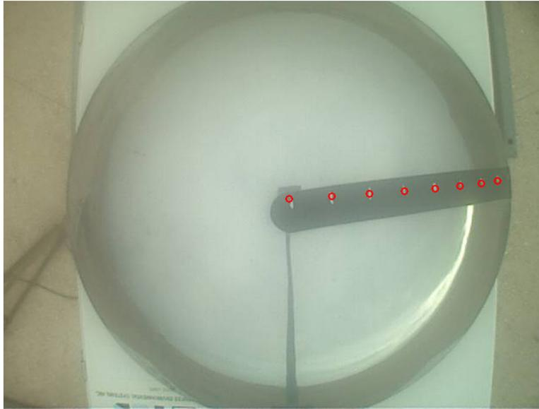
Figura 2.3: Imagen de control para realizar regresión. Contiene marcas en la banda de sombra. Puntos rojos representan la selección manual de las marcas para realizar el ajuste por mínimos cuadrados. En el [Apéndice B](#) se detalla el ajuste efectuado.
