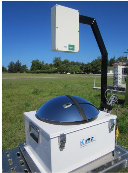
Figura 1.6: Dispositivo Total Sky Imager (TSI) fabricado por la empresa Yankee Environmental Systems Incorporated.
