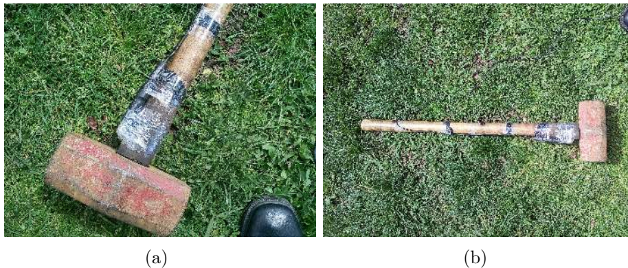
Figura 3.3: Martillo utilizado en terreno (a) y detalle del sensor (b).
