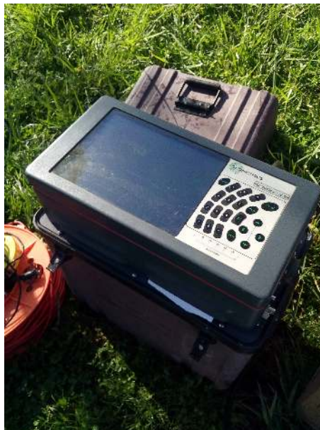
Figura 3.1: Equipo de registro sísmico Geode.
