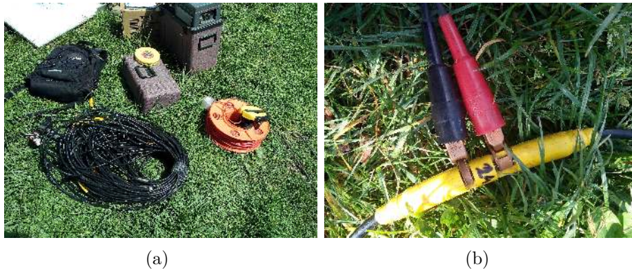
Figura 3.6: Cable sísmico para geófonos (negro) y para martillo (naranja) (a) y detalle de la conexión entre los cables del geófono al cable sísmico (b).
