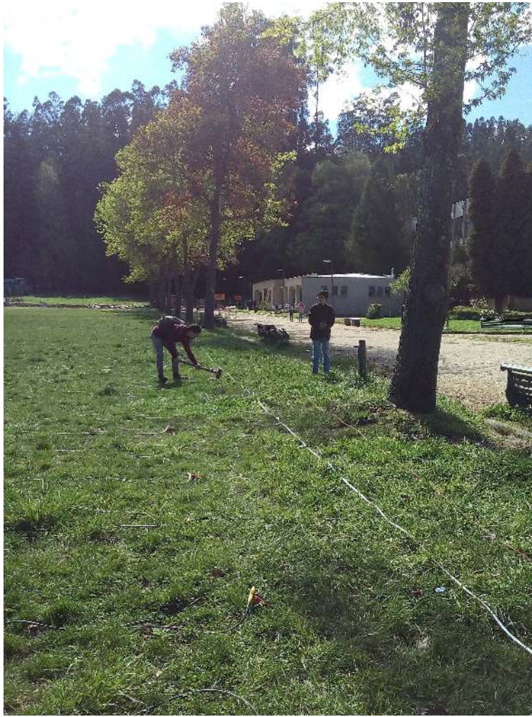
Figura 4.11: Vista del tendido lineal de geófonos en el momento de realizar el shot o golpe para la refracción sísmica.
