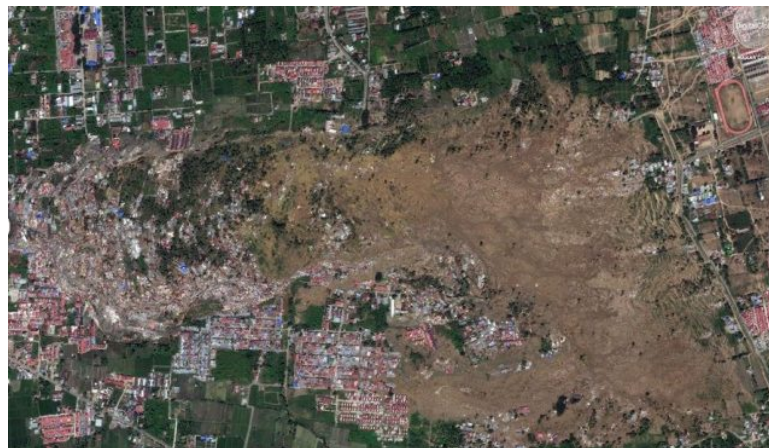
Figura 3: Imagen satelital de alta definición mostrando los daños causados por un deslizamiento subaéreo gatillado por el terremoto. Extraído de DigitalGlobe. The Landslide Blog. Ultimo acceso Abril 12, 2022.
