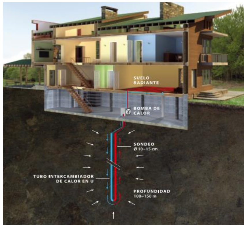
Figura 2.4: Durante los meses más fríos del año, se recoge el calor del subsuelo y se transfiere al edificio. Extraído de Ferroterm, 2015.
