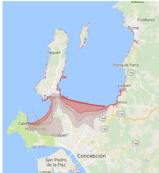
**Figura 26.** Mapa de inundación elaborado por el SHOA (ed. 2013). Desde la zona roja más oscura en la costa, hasta el más claro hacia el interior representan zonas de profundidad de inundación de 4-6 m, 2-4 m, 1-2 m y 0-1 m.
